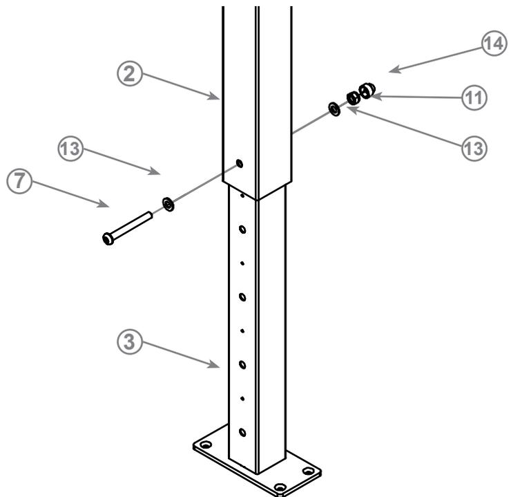
Schieben Sie den inneren Teil des Teleskoprohres (3) in den oberen Teil (2). Schieben Sie dann die Fixierschraube M8x70 (7) durch die vorgebohrte Öffnung. Verschrauben Sie diese von der Gegenseite mit einer Unterlegscheibe (13) und einer Schraubenmutter (11). Stülpen Sie die Abdeckkappe (14) über die Mutter.
