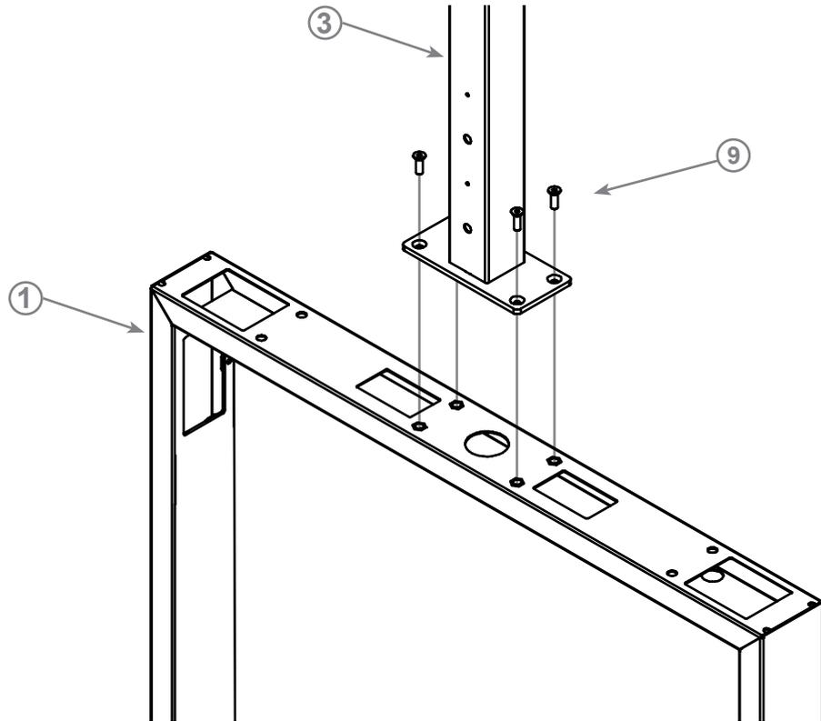
Verschrauben Sie den vormontierten Rahmen (1) mit dem Teleskoprohr (3), verwenden Sie dafür die M6x20-Schrauben (9).
