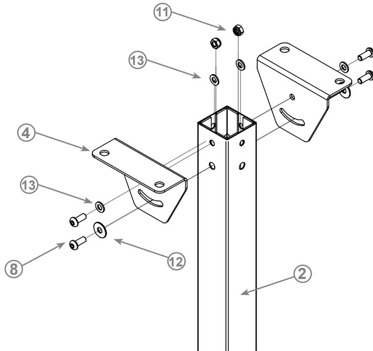
Verschrauben Sie die 2-teilige Deckenaufnahme (4) mit dem oberen Teil des Teleskoprohres (2). Fixieren Sie von innen mit Schraubenmutter (11) und Unterlegscheiben (13) und außen mit Unterlegscheiben (12), Unterlegscheiben (13) sowie M8x20-Schrauben (8).
