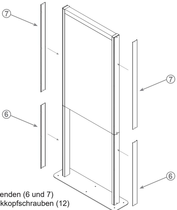
Setzen Sie die magnetischen, seitlichen Blenden (6 und 7) an die Tragsäulen. Verwenden Sie die Senkkopfschrauben (12) falls eine stärkere Fixierung notwendig ist.
