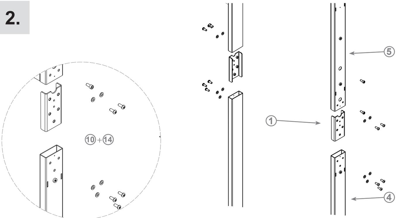
Verbinden Sie, mit Hilfe des Verbindungsankers (1) den oberen Teil der Tragsäule (5) mit dem bereits montierten unteren Teilstück (4), verwenden Sie M8x20-Schrauben (10) und Unterlegscheiben (14).
