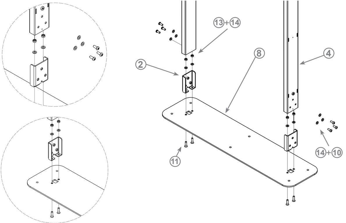
Verschrauben Sie die Verbindungsanker (2) sowie den unteren Teil der Tragsäulen (4) mit der Sockelplatte (8), verwenden Sie M8x20-Schrauben (10), M8x30-Schrauben (11), Unterlegscheiben (14) und Schraubmutter (13).
