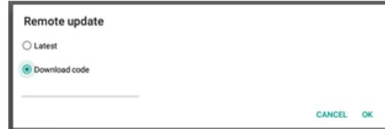
Tippen Sie auf „OK“ und warten Sie 5 Minuten (je nach Netzwerkgeschwindigkeit), bis „update.zip“ heruntergeladen wurde. Bei erfolgreichem Download überträgt das System die Datei automatisch an den Prozess „Local update“ (Local update (Lokale Aktualisierung)). Das System startet neu und führt die Systemaktualisierung durch. Bitte beachten:
