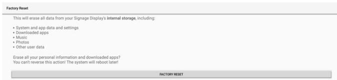
Tippen Sie auf „Factory Reset (Werkseinstellung)“ und Sie werden zur Bestätigung der Wiederherstellung aufgefordert. Beachten Sie, dass dadurch alle Daten vom internen Speicher gelöscht werden. Dieser Vorgang kann nicht rückgängig gemacht werden.
