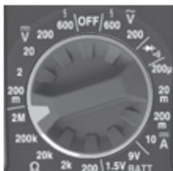
**HINWEIS:** Sind die Messleitungen in einer Widerstandseinstellung offen (nicht über einen Widerstand miteinander verbunden) oder wird ein defekter Widerstand gemessen, zeigt das Display „OL“ an. Das ist normal.
