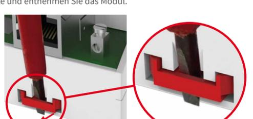
Drücken Sie nach dem Entnehmen des Moduls leicht auf die beiden Clips; sie springen wieder an ihre ursprüngliche Position zurück.
