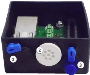
Abb. 25: Anschlussbox mit Gummistopfen Ethernet C.3 (1), Gummistopfen Einzeladern C.4 (2), USB-Stopfen (3) und zwei blauen Verriegelungsstücken
