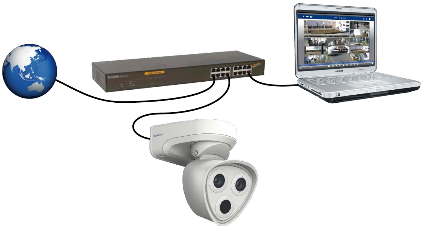
Abb. 24: Spannungsversorgung mit PoE-Switch nach PoE Plus (802.3at-2009)
