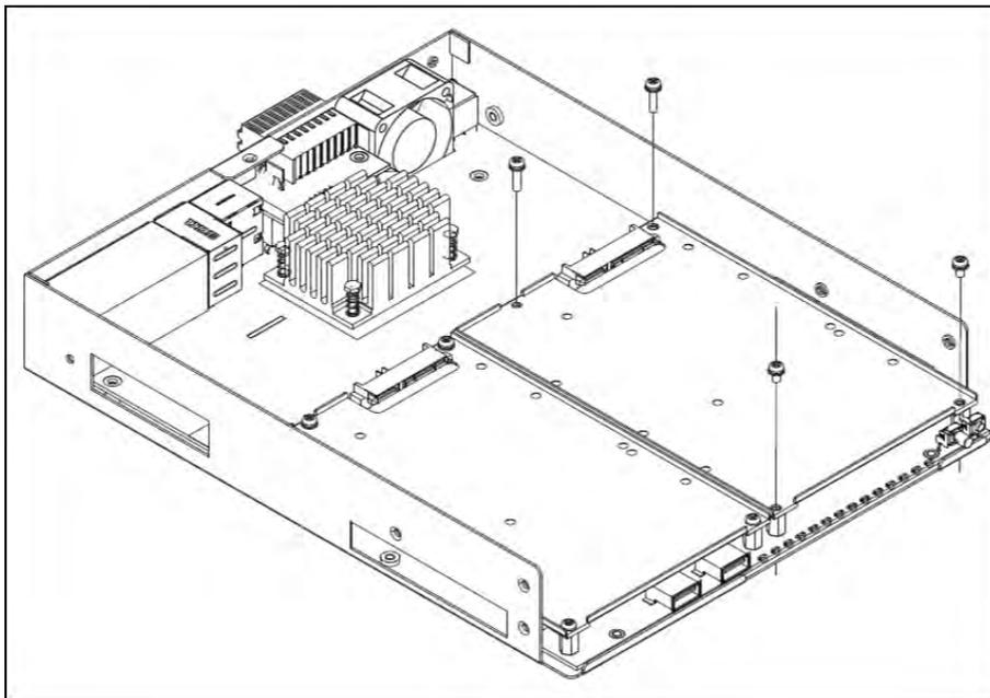
3. Befestigen Sie die Festplatte mithilfe der vier mitgelieferten Schrauben wie gezeigt an der Aufnahme.
