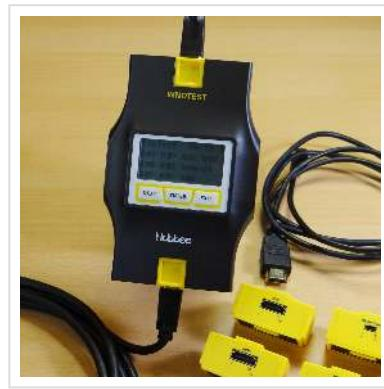
**Le testeur de câbles modulaire INNOTECH est la dernière innovation en matière de technologie de test sur le marché. Il s'agit du premier testeur de ce type dans la conception de modules. Il fonctionne avec des modules interchangeables afin que la connexion requise soit toujours disponible. Dans cette version, il est livré dans un étui avec 4 modules pour tester les câbles HDMI**
