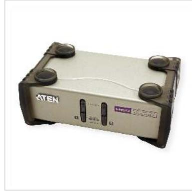
Le commutateur KVM PS/2-USB CS82U est une unité de contrôle de bureau qui permet aux utilisateurs d'accéder à deux ordinateurs à partir d'une seule console KVM (clavier et souris PS/2 ou USB, et moniteur VGA). De plus, le commutateur CS82U est doté de la nouvelle technologie DynaSync™ vidéo d'ATEN, qui élimine les problèmes d'affichage au démarrage et optimise la résolution.
