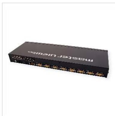
Le switch KVM CS1708A permet le contrôle de 8 serveurs via une console USB ou PS/2. Grâce au Daisy Chain, on peut gérer jusqu'à 256 serveurs. Un port USB en face avant permet à chaque serveur connecté d'avoir accès au périphérique connecté.
