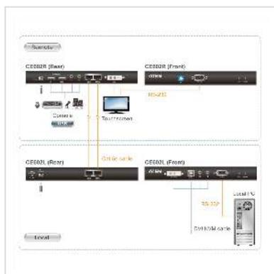
CE602 un prolongateur KVM à raccordement USB pour écrans Dual Link DVI. Il permet un accès déporté au PC depuis une console USB éloignée de 60 m.
