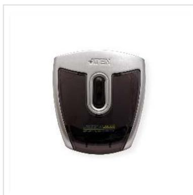
Le commutateur US221A est un commutateur de périphérique USB 2.0 à 2 ports qui permet à jusqu'à 2 ordinateurs de partager l'utilisation d'un même périphérique USB (tel qu'une imprimante, un scanner, un périphérique de stockage de masse, etc.) selon le principe « un à la fois ».
