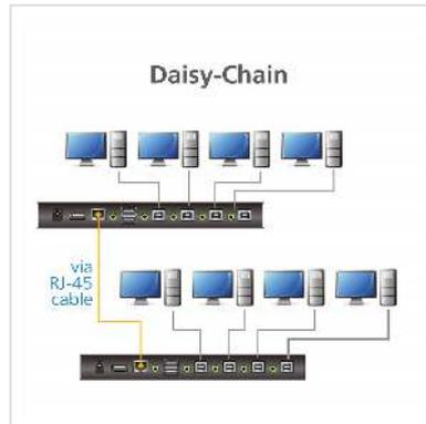
Le CS724KM est un commutateur KM USB à 4 ports qui permet aux utilisateurs de contrôler jusqu'à 4 ordinateurs avec un seul clavier et une seule souris. Deux commutateurs peuvent être connectés en chaîne pour permettre le contrôle de jusqu'à 8 ordinateurs à partir d'une seule console.
