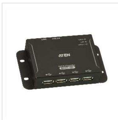
Le système d'extension Cat 5 USB 2.0 à 4 ports UCE3250 est un périphérique à deux unités qui sert de hub USB et de système d'extension USB. L'unité UCE3250 peut connecter jusqu'à 4 périphériques USB à une distance allant jusqu'à 50 mètres de votre ordinateur via un câble Ethernet Cat 5 / 5e / 6.
